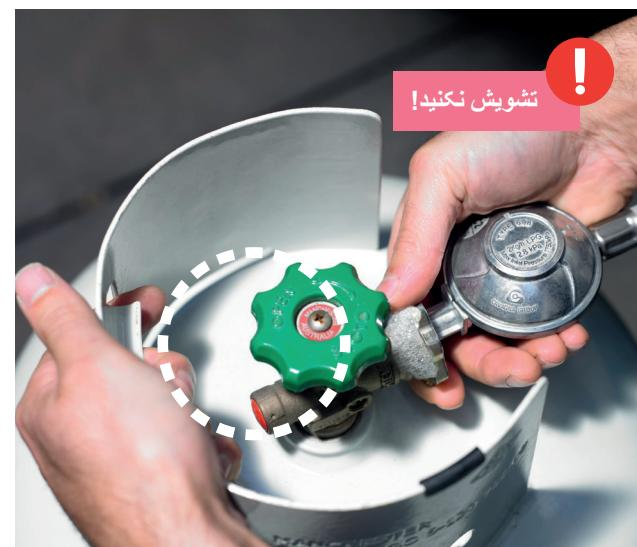
اطمینان حاصل کنید که پیپ گاز بداخل BBQ از بین نرقه و اتصالات آن محکم است. موجودیت سوراخ هارا با آب صابون بررسی کنید.
